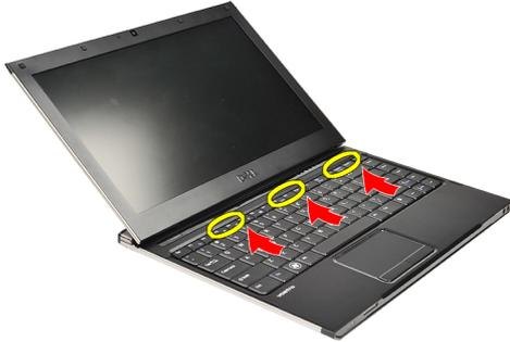
3. Puxe a tampa dos LEDs na direcção do teclado e reitre-a do computador.
