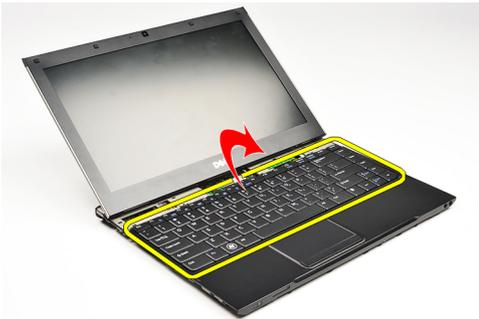
8. Levante o grampo para libertar o cabo do teclado e retire-o do computador.
