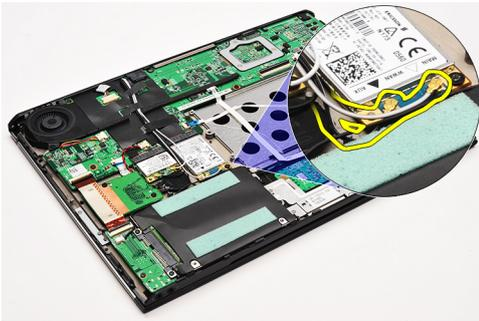
6. Retire o parafuso que fixa a placa WWAN ao computador.
