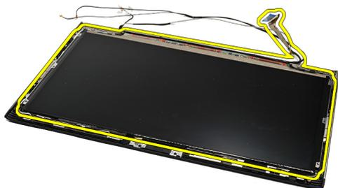
17. Retire a fita adesiva que fixa o cabo do ecrã, e puxe o cabo para fora do respectivo conector.
