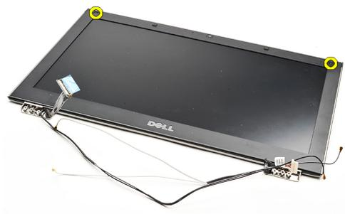
15. Utilizando um instrumento aguçado em plástico, levante por debaixo da moldura do ecrã para retirá-la do conjunto do ecrã.
