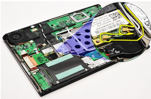
6. Retire o parafuso que fixa a placa WLAN ao computador.
