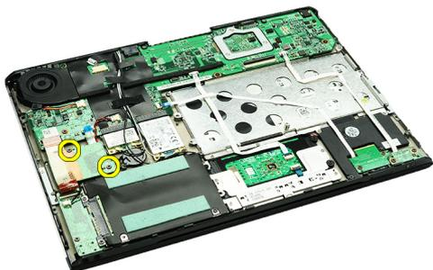
8. Levante a placa do leitor de cartões e retire-a do computador.
