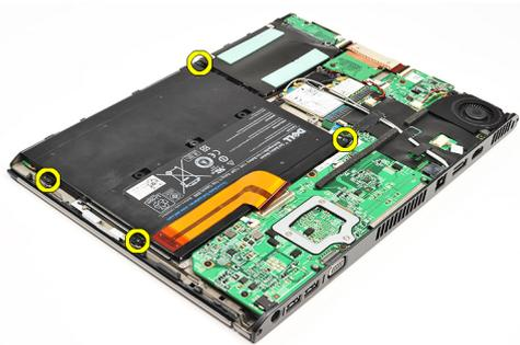
6. Levante a bateria e retire-a do computador.
