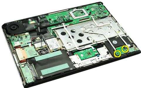
8. Retire cuidadosamente o cabo de dados da placa SIM do suporte metálico no computador.
