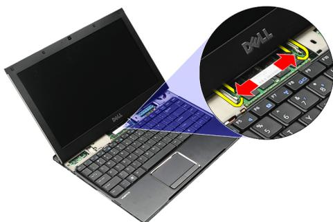
4. Retire o módulo de memória do respectivo conector na placa de sistema inclinando o módulo da placa de sistema num ângulo de 45 graus.
