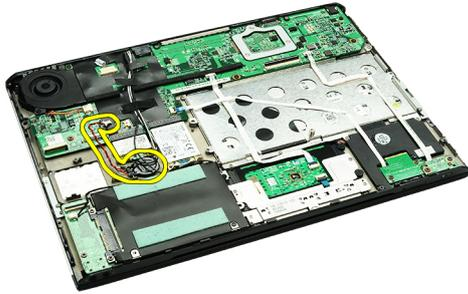
2. Ligue o cabo da bateria de célula tipo moeda à placa de sistema.
