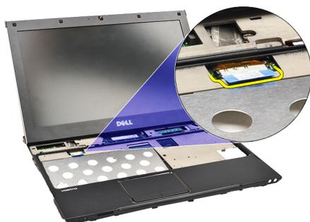
11. Volte o computador e retire as fitas de tecido para soltar os cabos das antenas do computador.
