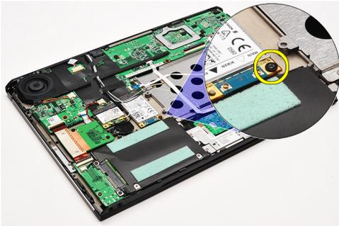
7. Deslize a placa WWAN para fora do respectivo conector e retire-a do computador.
