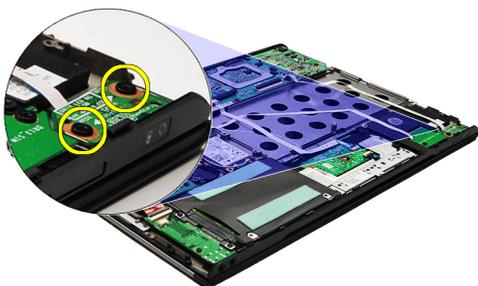
7. Levante o sensor de fecho do ecrã e retire-o do computador, juntamente com o respectivo cabo flexível.
