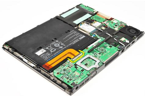
5. Retire os parafusos que fixam a bateria ao computador.
