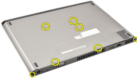
4. Deslize a tampa da base em direcção à parte frontal do computador. Levante-a e retire-a do computador.
