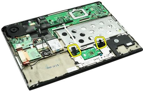
8. Desligue o cabo do painel táctil do respectivo conector na placa de sistema.
