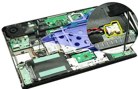
7. Levante e retire a bateria de célula tipo moeda do computador.
