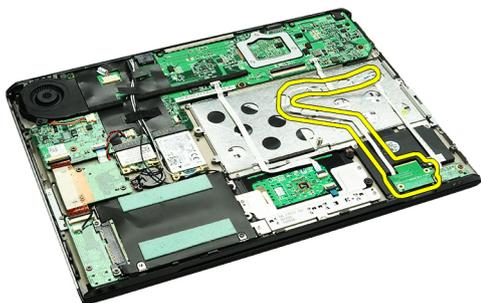
9. Levante a placa SIM e o cabo de dados da placa SIM e retire-os do computador.
