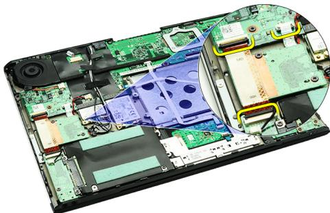
7. Retire os parafusos que fixam a placa do leitor de cartões ao computador.
