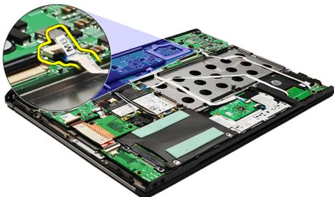
6. Retire os parafusos que fixam o sensor de fecho do ecrã ao computador.
