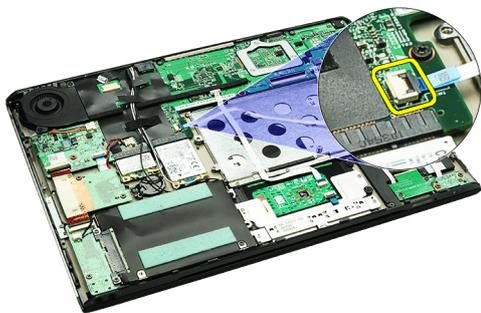
7. Retire os parafusos que fixam a placa SIM ao computador.
